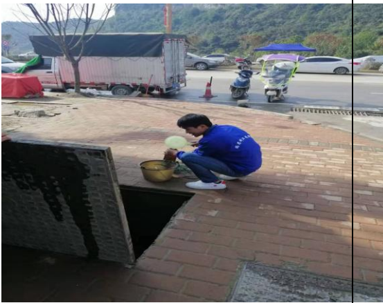
化粪池总排口取样照片
