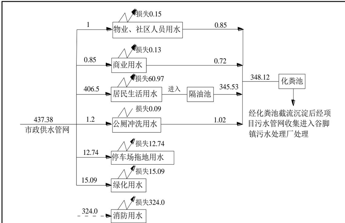
图 2-1 项目水平衡图 单位: m<sup>3</sup>/d
